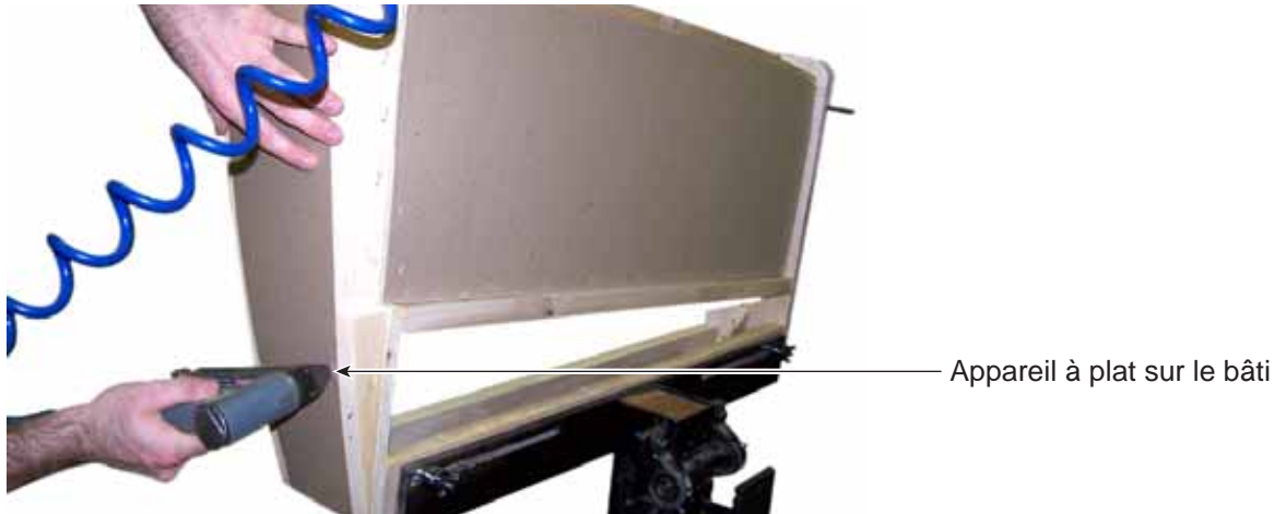
Figure C1.5.8 Utilisation de l'agrafeuse pneumatique
