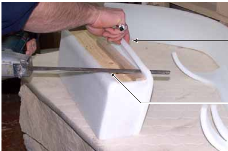
Figure C1.5.12 Utilisation du couteau électrique
