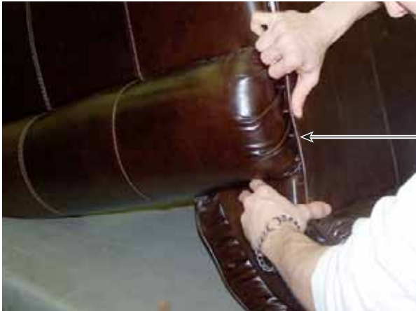
Figure 3.2.5 Utilisation de la bande métallique rigide (suite)
