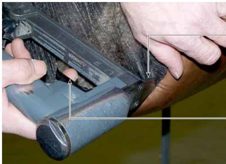
Figure 3.1.9 Utilisation de l'agrafeuse pneumatique
