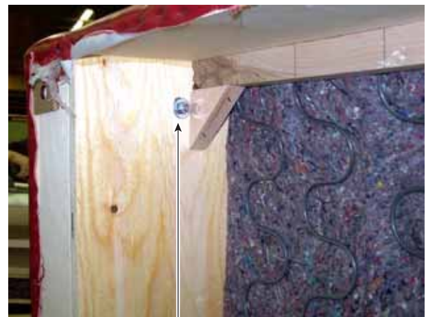
Fixation des accoudoirs à l'aide d'un écrou
