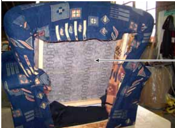
Figure 3.2.4 Fixation de l'arrière du dossier
