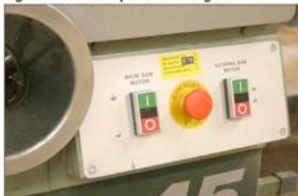
Les ponceuses à bande large sont des machines-outils comportant des risques de combustion lors de leur utilisation. Ces combustions commencent souvent à l'intérieur de la machine-outil elle-même et génèrent un front de flammes qui se propage vers le dépoussiéreur. Les sources d'inflammation sont généralement des étincelles ou l'échauffement du papier sablé sur le bois. Il y a même un risque d'explosion lorsqu'il s'agit d'un dépoussiéreur fermé.
