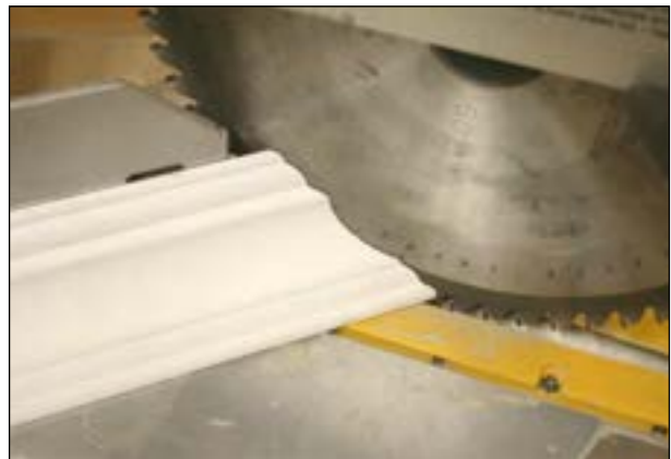
Figure C5.2.22 Coupe combinée de la moulure
