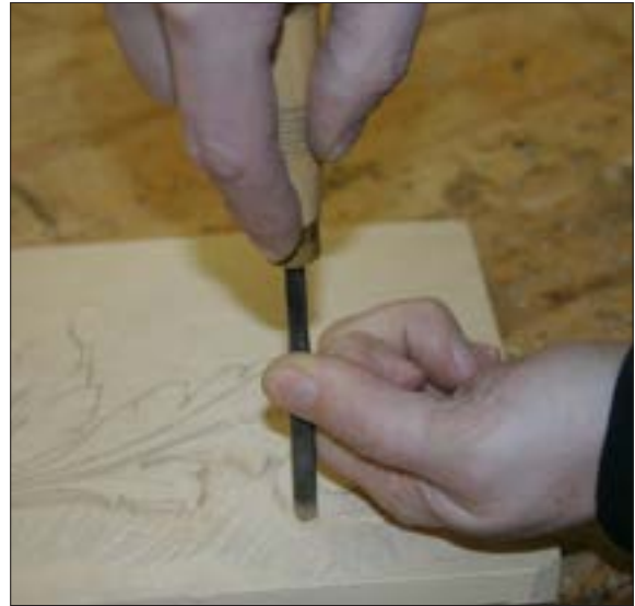
Figure C4.6.2 Utilisation d'une gouge à la verticale
