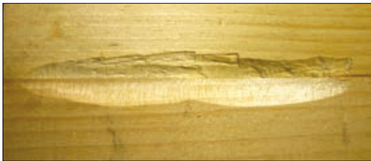
Figure C4.4.6 Pièces positionnées dans le sens contraire des fibres
