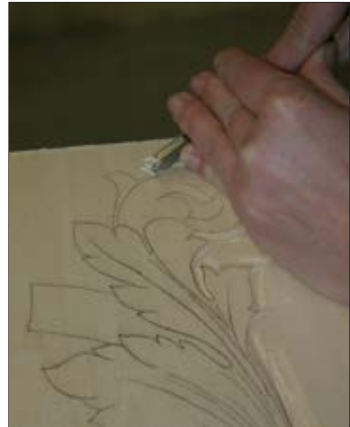
Figure C4.6.1 Détournage au burin
