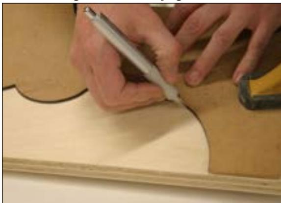
Figure C2.3.3 Traçage et hachurage de la pièce à découper
