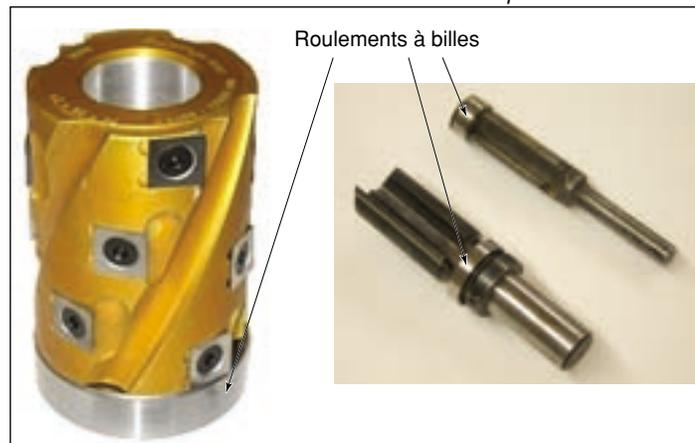
Prenons comme exemple la défonceuse fixe. Si on utilise cette machine avec un outil de coupe du même diamètre que le doigt qui vient suivre le gabarit, la forme de ce dernier sera alors identique à ce que l'on souhaite obtenir (figure C2.1.3).
