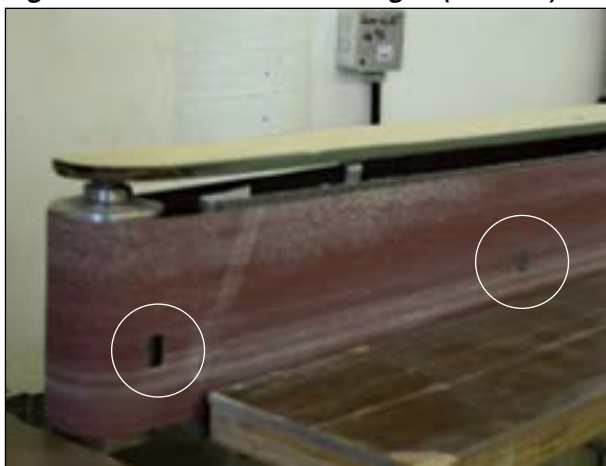
Figure 5.1.43 Bande endommagée (CCDMD)
