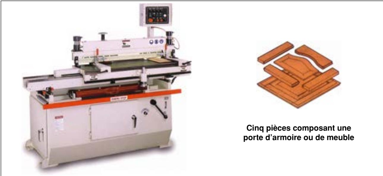
À noter qu'il est également possible d'obtenir des moulures profilées d'une seule pièce. Cependant, lorsqu'il est prévu que les moulures seront peintes, et par mesure d'économie, on aboute des pièces de différentes longueurs; c'est ce qu'on appelle l'assemblage à entures. Dans une production en série, cette opération s'effectue sur une chaîne d'aboutage à grand rendement (figure 4.7.7).
