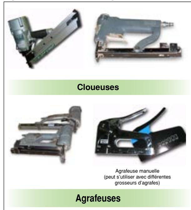
Les fabricants offrent plusieurs types de cloueuses et d'agrafeuses. Leur capacité respective varie en fonction de la longueur et du calibre des clous et des agrafes à utiliser. Il est très important de s'assurer que les agrafes et les clous utilisés soient compatibles avec la marque de l'outil qu'on utilise.
