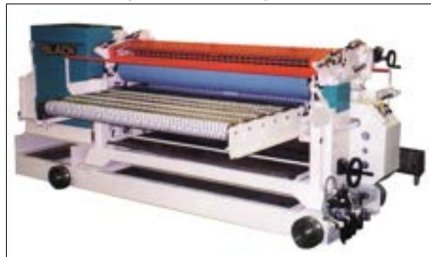
L'encolleuse à rouleaux doseurs (figure 4.1.21) améliore le réglage du grammage de la colle. Aux cylindres rainurés s'ajoutent des rouleaux lisses qui permettent de laminier une épaisseur de colle régulière; cette épaisseur de colle se règle à l'aide de vis micrométriques. Les machines modernes sont contrôlées électroniquement.
