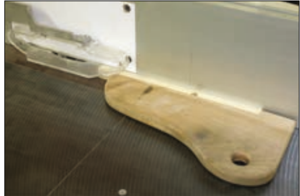
Figure 3.2.18 Exemple de poussoir pour pièce de petite dimension
