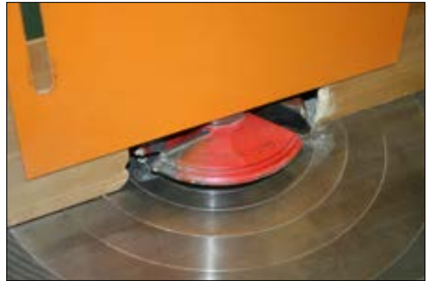
Figure 3.2.6 Minimisation des ouvertures autour de l'outil
