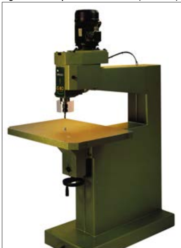
Figure 3.2.1 Toupie-défonceuse fixe (Normand)
