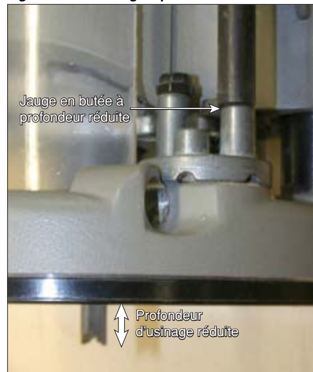
Figure 3.2.27 Usinage à profondeur réduite
