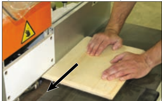
Figure 3.2.14 Position des mains sur la pièce à usiner
