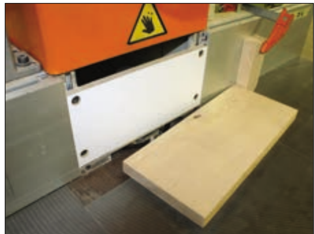
Figure 3.2.17 Butée pour usinage arrêté
