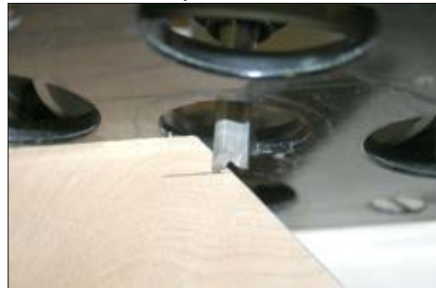
Figure 3.2.31 Réglage de profondeur à l'aide d'une pièce de bois
