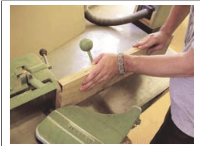
Déposer les mains sur le haut de la pièce et s'assurer qu'aucune partie des mains ne touche à la table de fonte.
