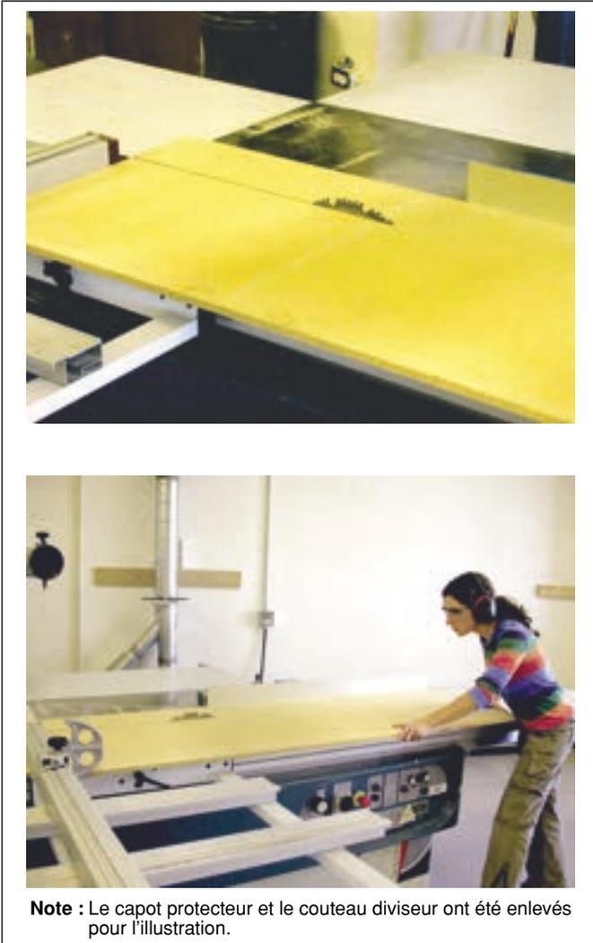
Placer le guide à refendre derrière la lame pour éviter le danger de projection vers l'arrière de la chute lorsque la coupe est terminée.
