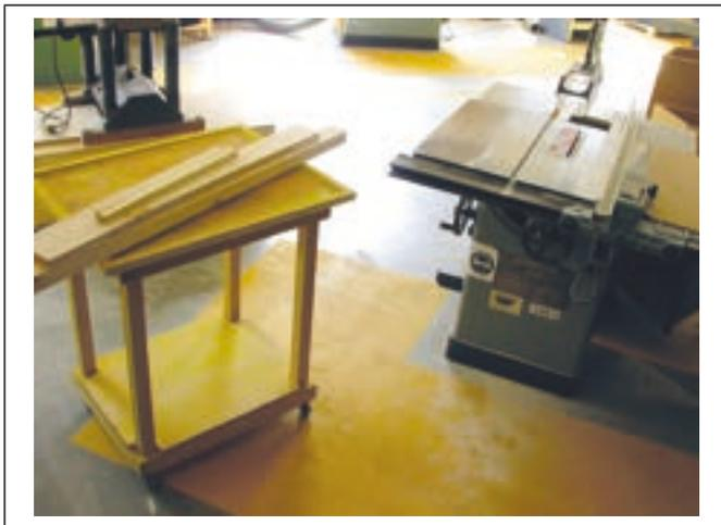
Déposer les pièces à usiner sur un chariot pour éviter d'encombrer inutilement la table du banc de scie.
