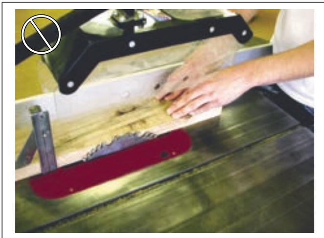
Ne pas pousser à deux mains sur la pièce près de la lame. La main gauche doit rester stationnaire sur la table du banc de scie et guider la pièce.
