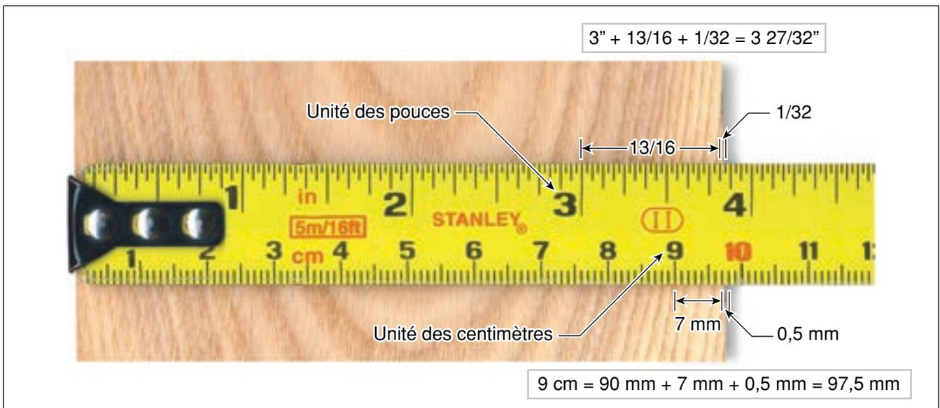
Le crochet situé à l'extrémité du ruban a un jeu, lequel permet un léger mouvement afin de prendre des mesures intérieures ou extérieures (figure 2.2.3). On doit s'assurer de ne pas déformer ce crochet, car la lecture de la mesure sera faussée.
