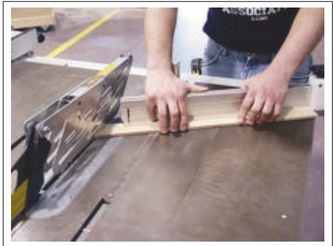
Pour des pièces très longues, il est possible de refendre en inversant leurs extrémités (figure 2.3.72). Lors d'un sciage de biseau (chanfreinage) (figure 2.3.73), s'assurer que la lame n'est pas en contact avec le guide à déligner. Si c'est le cas, prévoir une protection s'emboîtant sur le guide pour ne pas l'endommager, puis usiner ce protège-guide avec précision afin qu'il tienne sur le guide uniquement par pression (figure 2.3.74).
