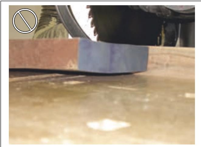
Mauvais point d'appui. S'assurer que la pièce est bien appuyée sur la table et contre le guide.
