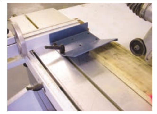
Afin de redresser une longue planche de bois massif, utiliser un accessoire approprié pour fixer la pièce et une lame à refendre; la pièce doit être fermement maintenue contre le guide.
