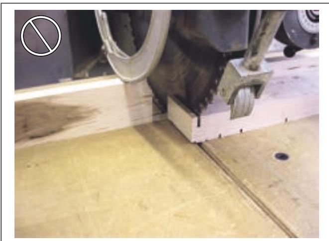
La lumière (espace entre le bout du guide et le côté de la lame) sur la butée est trop grande. Les petites pièces rebuts peuvent être entraînées par la lame et projetées contre l'opérateur. Changer la butée.
