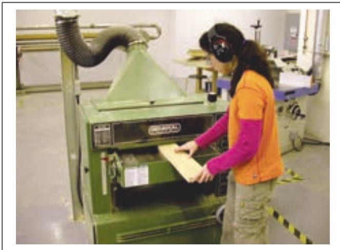
Se placer hors de la ligne de projection du rejet de la pièce. Engager la pièce fermement, une main sur la pièce et l'autre à l'arrière, jusqu'à ce que le rouleau entraîneur ait pris la pièce en charge.
