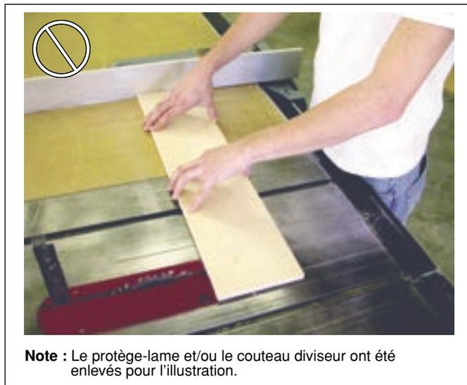
Ne pas utiliser le guide à refendre pour couper des pièces dont l'appui sur ce guide est insuffisant.
