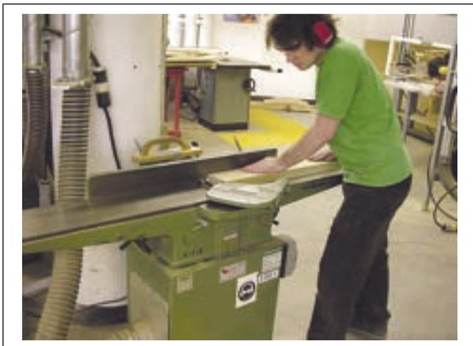
Pour dégauchir, se positionner tout prêt de la machine, le pied gauche pointé vers l'avant.
