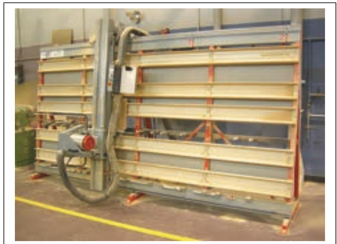
La grosseur d'une scie est déterminée par la dimension du plan de travail. Généralement, cette scie offre la possibilité de débiter des panneaux de 5 pi par 12 pi. Sa capacité maximale en épaisseur est le plus souvent de 1 po.
