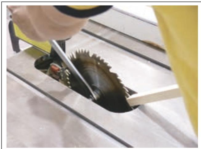
**Figure 2.3.67** Vissage de l'écrou pour réinstaller la lame
