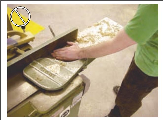
Ne jamais nettoyer la table avec les mains pendant que la machine est en marche. Si nécessaire, souffler sur le bran de scie.
