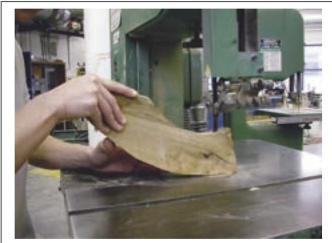
Pour les pièces cintrées, s'assurer que la pièce est bien appuyée sur la table lorsqu'elle entre en contact avec la lame.
