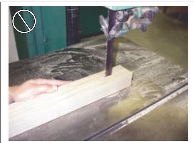
La position du guide-lame est trop haute au-dessus de la pièce. Il y a danger de blessure aux mains à la fin de la coupe.
