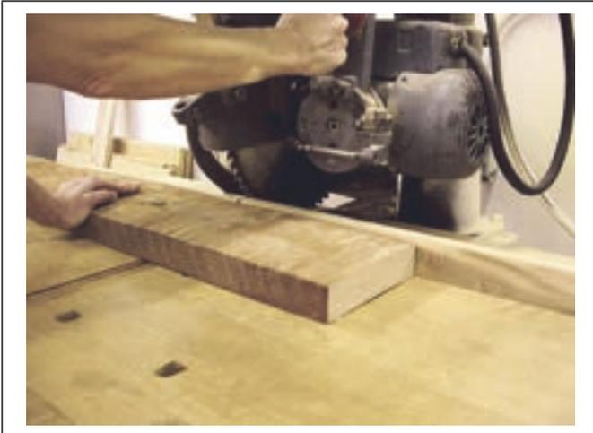
Placer la pièce à tronçonner de façon qu'elle soit stable sur la table et bien appuyée contre le guide
