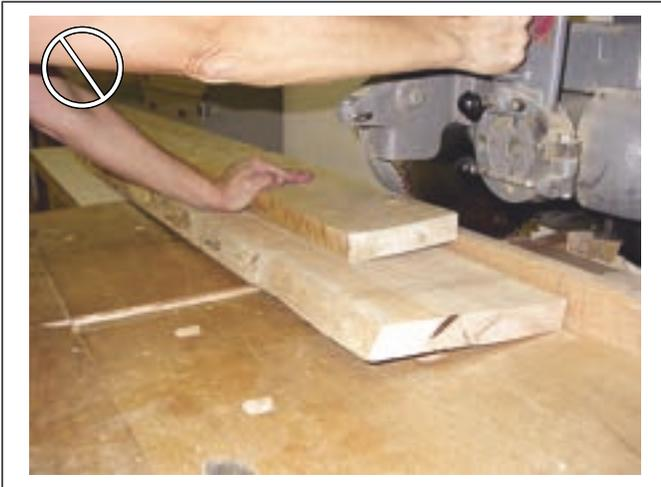
Ne pas superposer des pièces de bois brut (pièces de bois qui n'ont pas encore été dégauchies ou rabotées) pour les tronçonner. Plusieurs pièces gauches (courbes, tordues, cintrées, etc.) superposées créent un appui instable sur la table.
