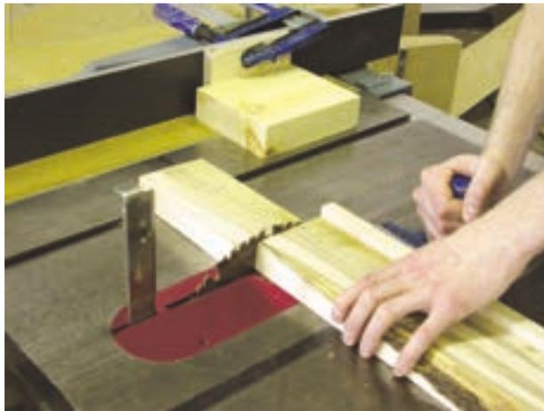
Si une butée de départ est utilisée, laisser un dégagement suffisant vis-à-vis la lame pour que la pièce tronçonnée ne soit pas coincée entre le guide et la lame. Le dégagement devrait être au moins plus grand que la diagonale de la pièce.
