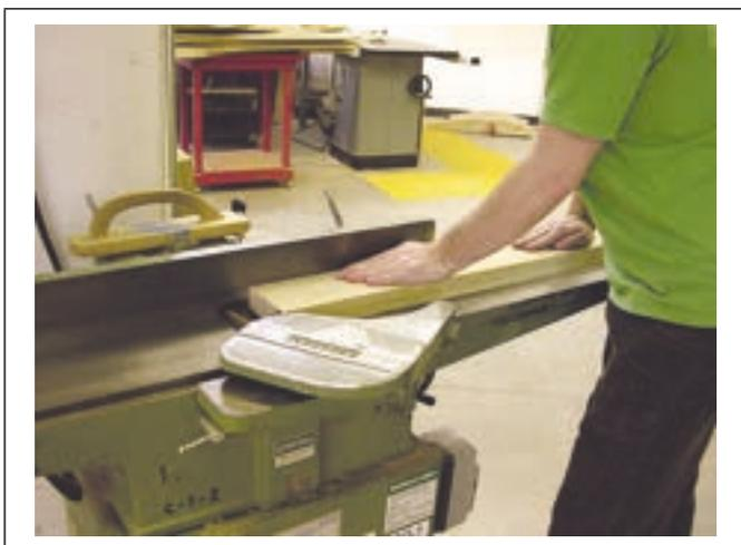
S'assurer que la main gauche n'est pas à moins de 150 mm (6 po) de l'avant de la pièce et qu'aucune partie des mains ne touche à la table de fonte.
