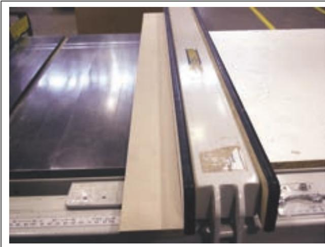
**Figure 2.3.62** Vérification de l'équerrage entre la surface de la table et la partie verticale du guide
