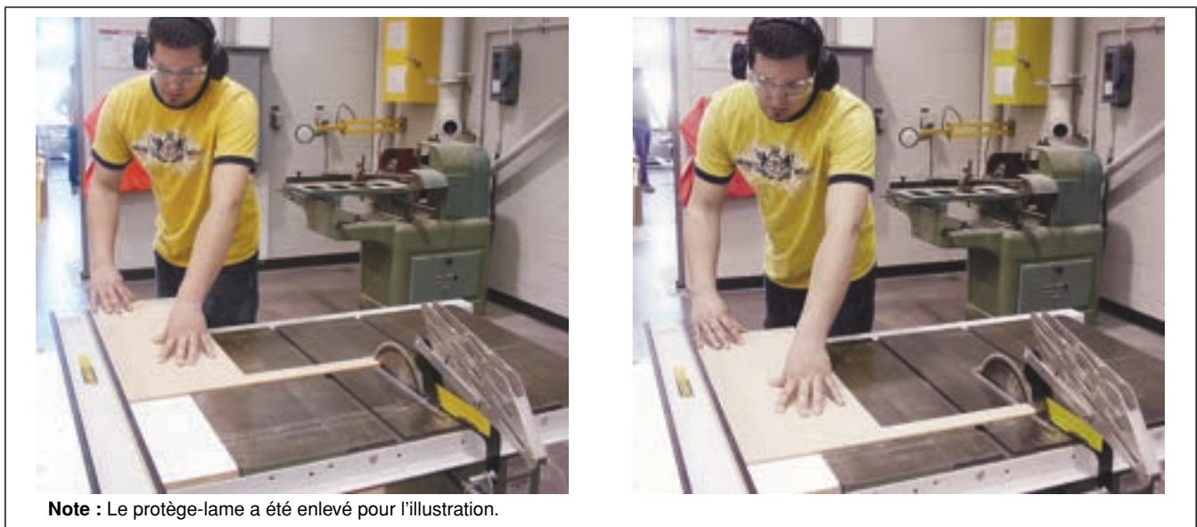
La lecture de la mesure sur la règle du guide à délimiter doit être identique à la lecture qui est faite sur la pièce qui a été délimitée (figure 2.3.65). Si ce n'est pas le cas, un ajustement est nécessaire. Cette mesure doit être vérifiée après chaque changement de lame.
