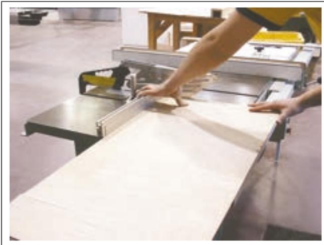
**Figure 2.3.71** *Coupe avec un angle ouvert pour plus de sécurité*
