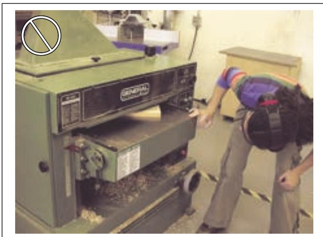
S'il y a blocage de la pièce, ne pas se pencher vis-à-vis de l'entrée ou de la sortie des pièces pendant que la machine est en marche; il y a un risque de rejet violent de la pièce.
