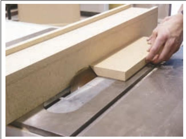
Figure 2.3.74 Protection s'emboîtant sur le guide
