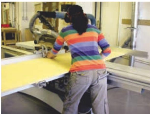
Toujours utiliser la barre de maintien comme point d'appui lorsqu'on travaille avec le chariot coulissant. Deux positions couramment utilisées sont illustrées ici.
