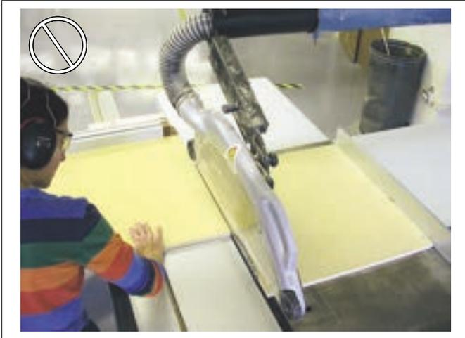
Le guide à déligner, placé dans cette position, peut provoquer un rejet violent de la pièce lorsque la coupe est terminée. Reculer le guide à déligner derrière la lame.
