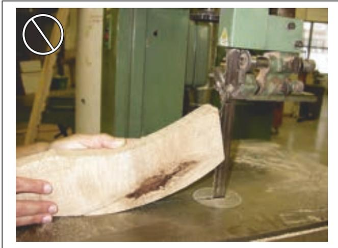
La pièce de bois doit toujours être appuyée sur la table lorsqu'elle s'engage dans la lame.
