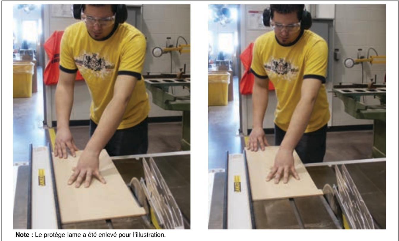
Pour vérifier le bon ajustement du rail qui supporte le guide à déligner, répéter l'opération précédente en positionnant le guide à 600 mm (2 pi), 900 mm (3 pi) et, si cela est possible, à 1 200 mm (4 pi) (figure 2.3.64). Si l'ouverture du guide à déligner change, c'est sur l'ajustement du rail qu'il faut travailler et non plus sur l'ajustement du guide à déligner.
