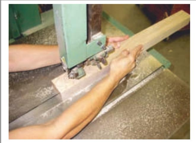
Tirer la pièce avec les mains derrière la lame pour terminer la coupe.
