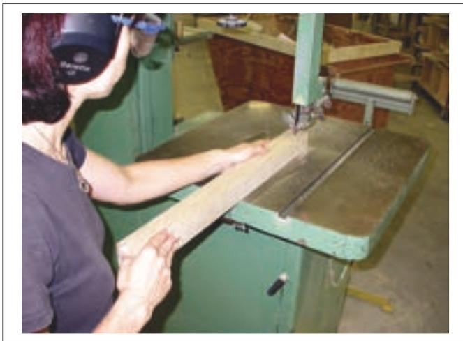
Déposer une main sur la table à environ 50 à 75 mm (2 à 3 po) de la lame, elle servira de guide pour engager la pièce dans la lame.
