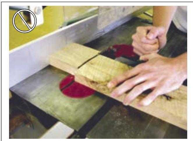
Ne pas utiliser le guide à déligner comme point d'appui continu pour tronçonner. Il y aurait alors risque de projection d'une pièce rebut qui se trouverait coincée entre le guide à déligner et la lame.
