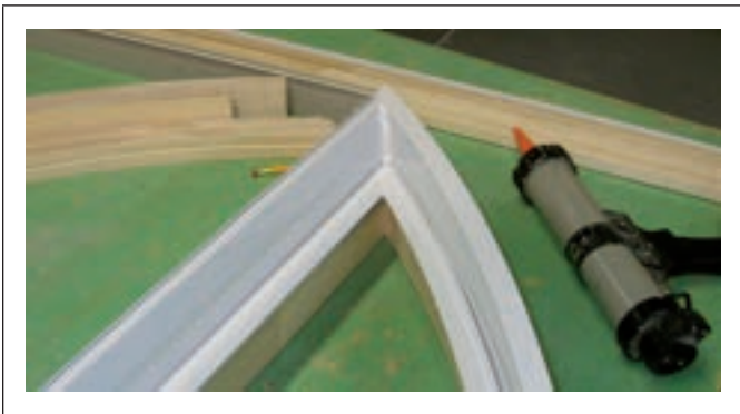
Figure C9.3.55 Taillage du recouvrement de la tête
