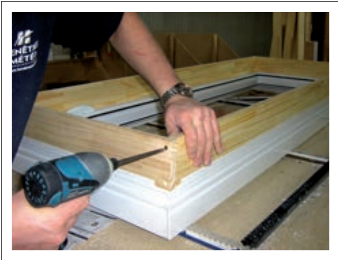
Figure C9.5.10 Vissage des montants
