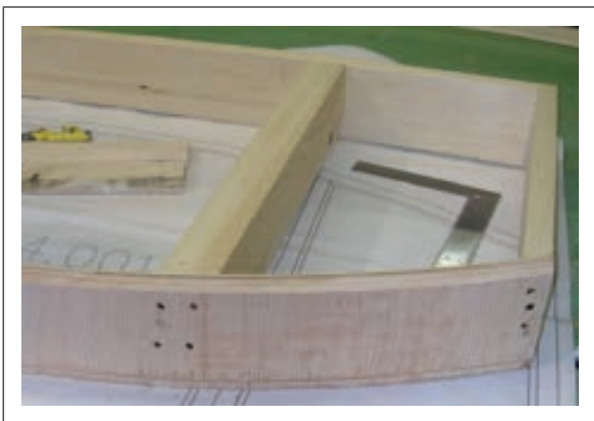
Figure C9.3.41 Vissage du recouvrement sur la tête
