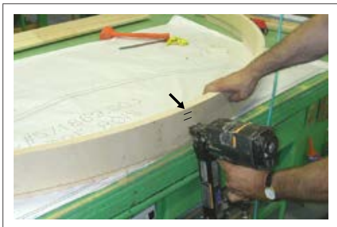
Figure C9.3.34 Brochage à l'extérieur des sections de l'arc
