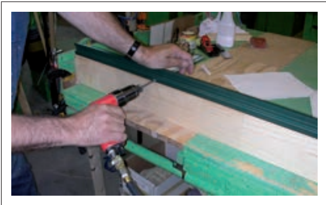
Figure C9.3.11 Taillage des extrémités des moulures
