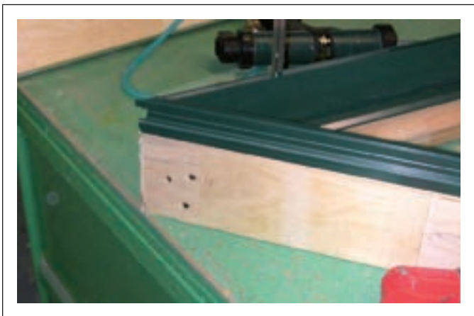
Figure C9.3.23 Vissage des recouvrements
