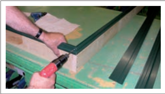
Figure C9.3.10 Vissage des recouvrements sur le cadre
