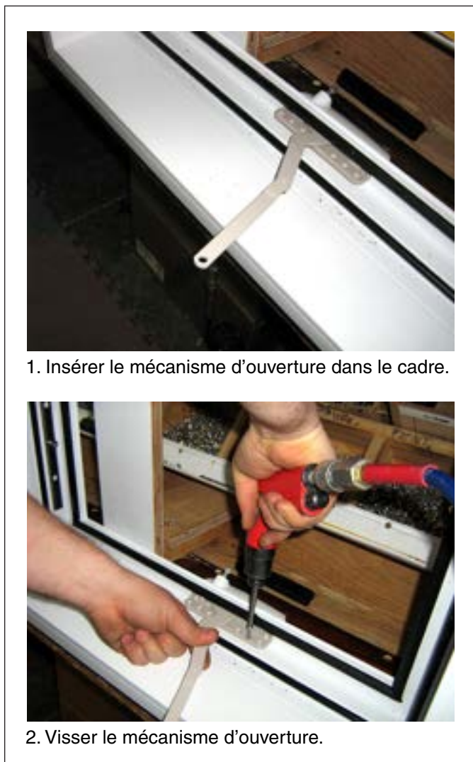
Figure C9.5.5 Fixation du mécanisme d'ouverture
