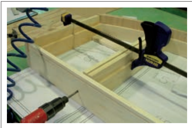
Figure C9.3.40 Fixation du meneau sur la tête
