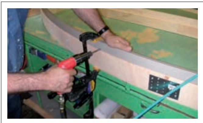
Figure C9.3.41 Vissage du recouvrement sur la tête
