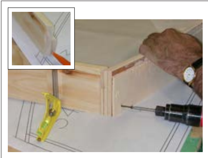
Figure C9.3.37 Vissage de la base avec les côtés
