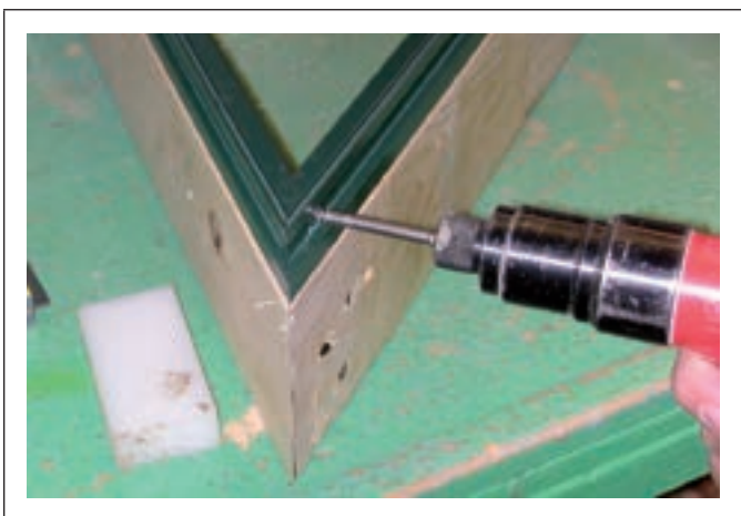
Figure C9.3.23 Vissage des recouvrements
