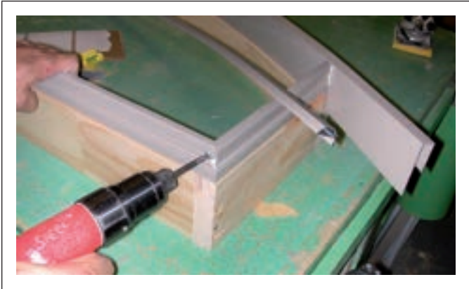
Figure C9.3.48 Perçage et vissage du recouvrement de la tête
