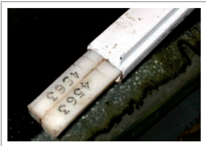
Figure C8.2.27 Insertion des barres anti-déformation dans les profilés
