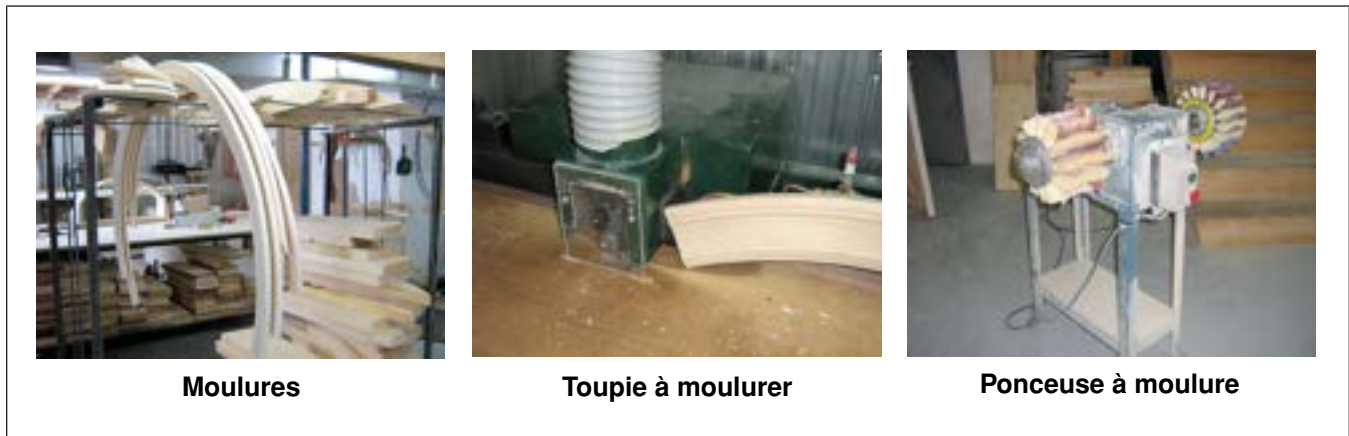
Figure C8.2.19 Moules intérieures, toupie et poncée à moule
