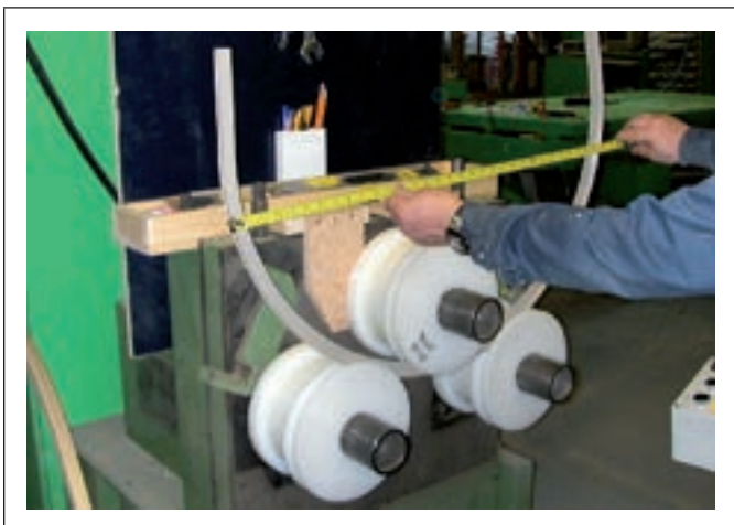
Figure C8.2.44 Vérification du diamètre
