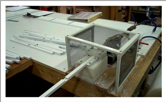
4. Percer les extrémités des barres avec la perceuse afin de poser plus tard les ressorts de retenue.
