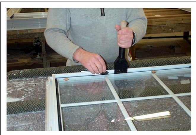
6. Installer les cales et mettre du scellant pour les retenir.
