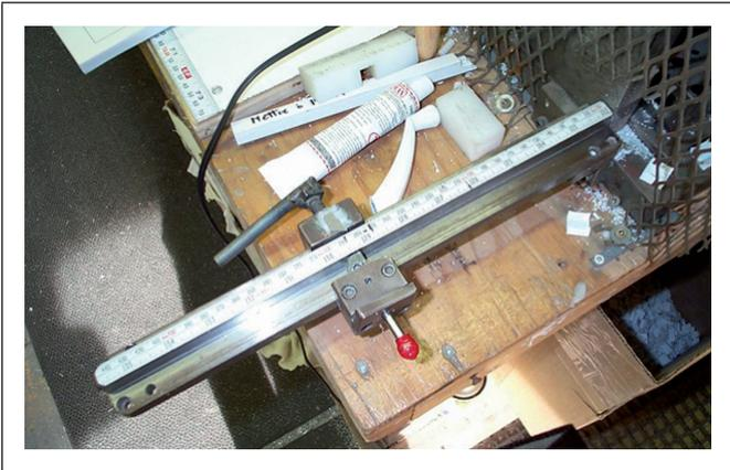
2. Ajuster le guide de la poinçonneuse en fonction des résultats obtenus lors des calculs.
