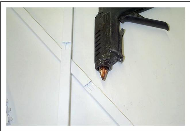
5. Assembler le carrelage en appliquant de la colle dans les coches d'assemblage de chaque barre.
