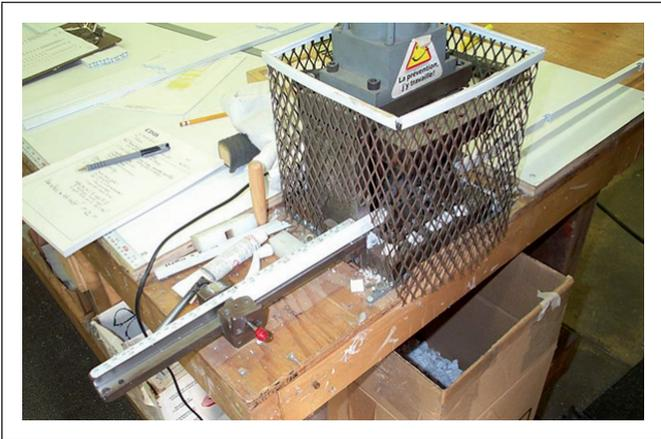
3. Insérer la barre dans la poinçonneuse, puis l'activer. Encocher les barres horizontales, puis la barre verticale selon les mesures.
