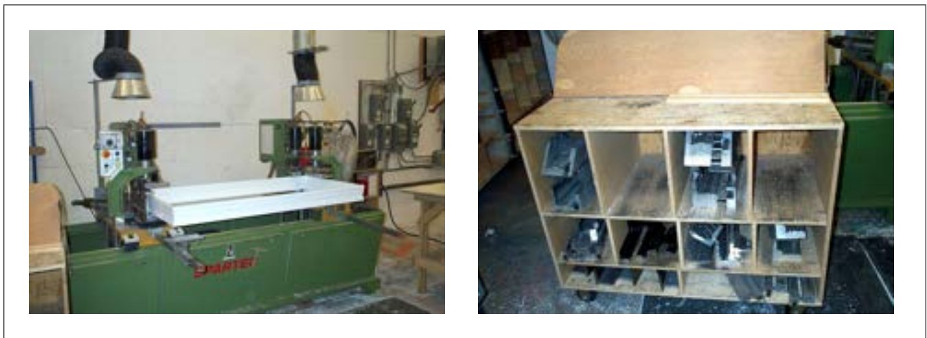
Figure 4.4.12 Poste de soudage et matrices
