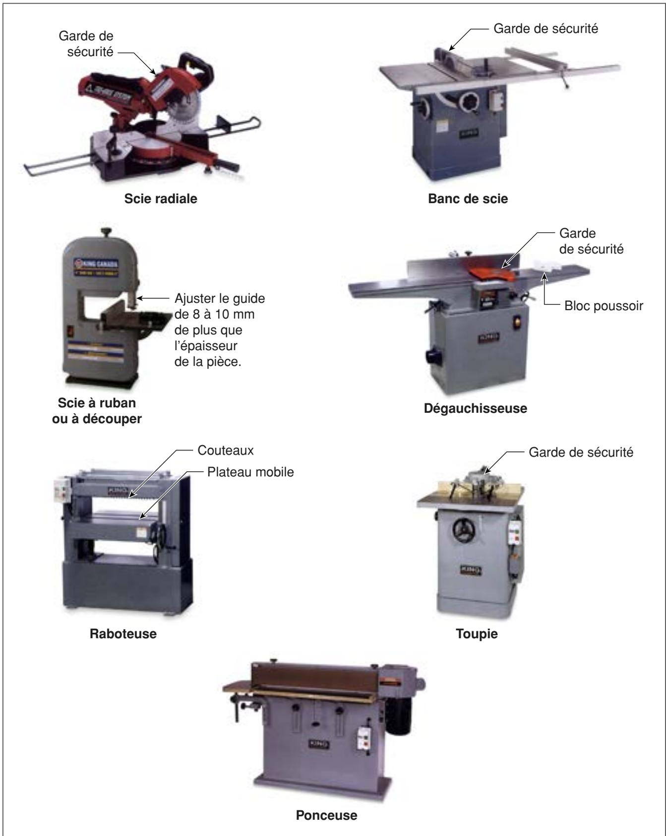
La scie radiale est surtout utilisée pour le coupage des matériaux en longueur, tandis que les coupes en largeur sont réalisées sur le banc de scie. Quant à la scie à ruban, elle sert à couper les formes en courbe.
