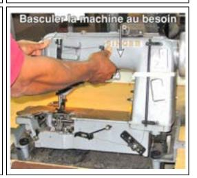
4. Nettoyer les composants de la machine au jet d'air avant de procéder à leur lubrification.
