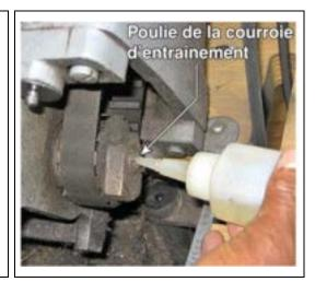
Ouvrir le boîtier de la tête de la machine et lubrifier les différents points d'appui et de glissement de la machine à coudre, conformément aux recommandations du fabricant.
