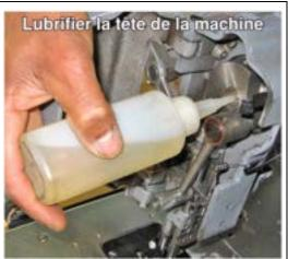
Retirer la plaquette donnant accès aux composants internes de la machine et lubrifier les composants mobiles.
