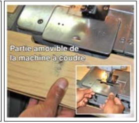
À l'aide d'un jet d'air ou d'un pinceau, enlever les fibres de matériau de recouvrement s'étant accumulées autour des composants.
