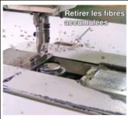
Au besoin, basculer la machine vers l'arrière pour nettoyer les composants ou pour accéder aux différents points de lubrification.
