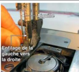
Récupérer le fil de la canette en tournant manuellement le système d'entraînement de la machine à coudre.
