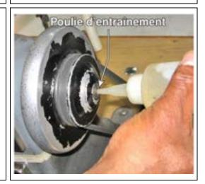
Lubrifier les différents points d'appui ou de glissement de la poulie de la courroie d'entraînement de la machine.
